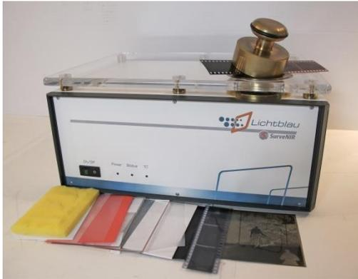
Das SurveNIR System bestehend aus dem NIR-Spektrometer, einem Notebook, der Steuerungssoftware und den in Applikationen integrierten Analysemethoden.
