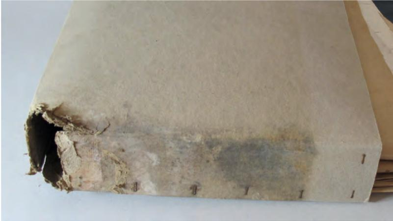
Abb. 4 – Wasser-/ Schimmelschaden an der Box Luttensee.
