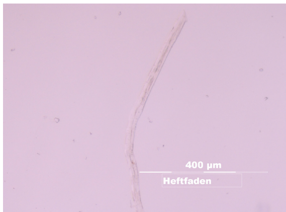
Abbildung 24: Eine Faser des Heftfadens im Durchlicht.
