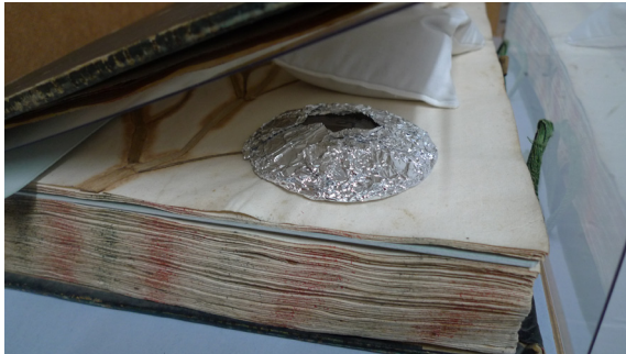
Abbildung 44: Mit Alufolie abgedichteter Sammler 5 auf Pflanzenblatt auf S. 15 in ES70.4.
