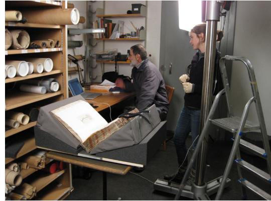
Abbildung 99: Aufnahmesituation: Jürg Bernhardt löst am Laptop die Kamera aus, die auf dem Säulenstativ (rechts im Bild) befestigt ist und die hier zu sehende Seite fotografiert. Fotografie Petra Hanschke
