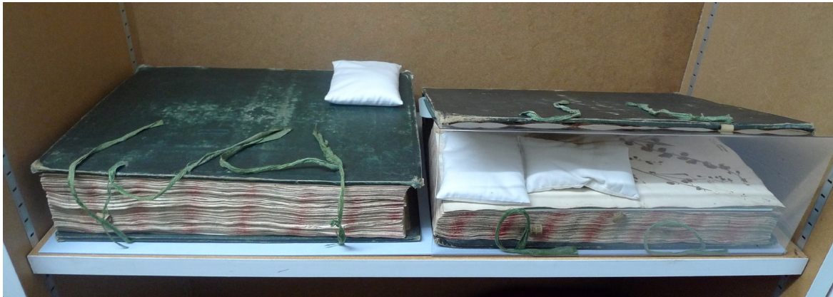
Abbildung 45: Ansicht des Versuchsaufbaus. Unter den Sandsäckchen befinden sich die mit dem Uhrglas abgedeckten Passiv-Sammler: Links ES70.6, rechts ES70.4 mit der PETG-Stütze.
