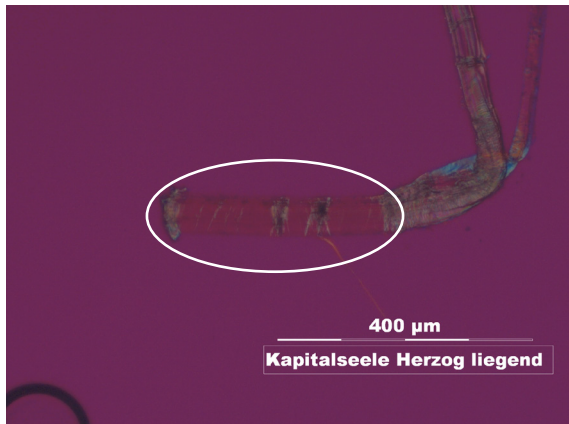
Abbildung 22: Die Kapitalseele-Faser erscheint im Herzogtest liegend rot.
